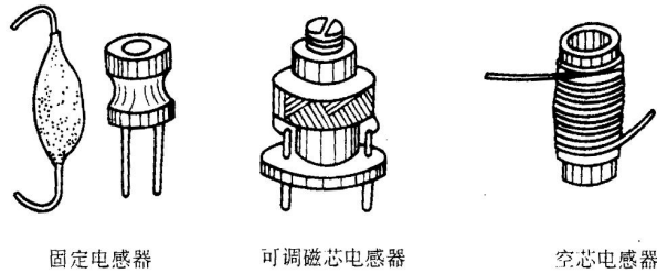
图 1.20 电感器的外形示意图
