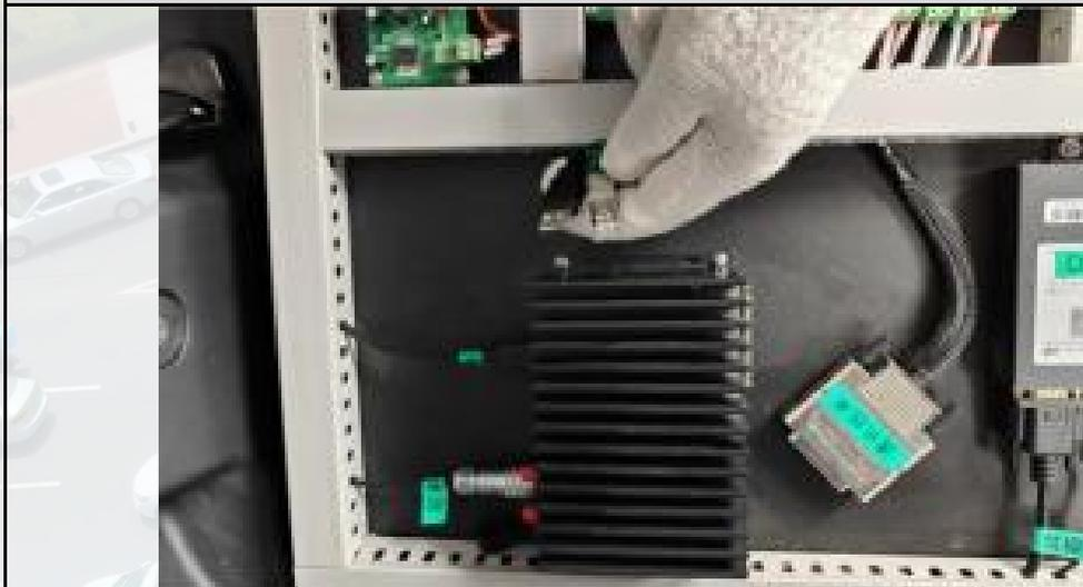
3. 断开计算平台左侧的电源接口、HDMI接口。
