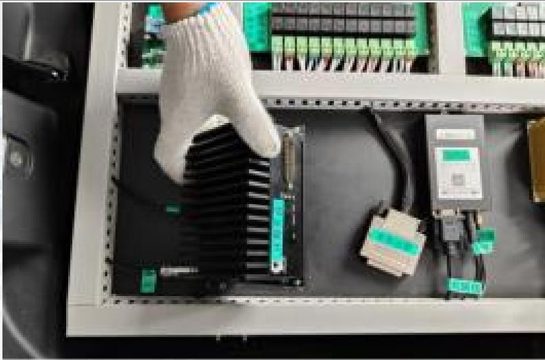
2. 选择型号合适的十字槽螺丝刀，安装计算平台的四个固定螺栓，四颗螺栓按对角顺序紧固，紧固力矩8-10N•m。
