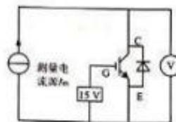
图 1 小电流下饱和压降测量电路
