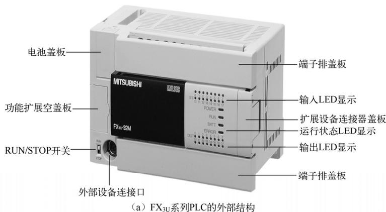
图 3.43 FX<sub>3U</sub> 系列 PLC 外部结构及端子接线
