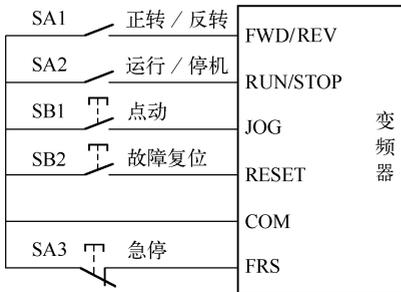
图 1.57 两线控制方式 2
